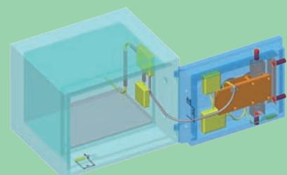
**Konstruktion:** Mehrwandiger Korpus und Tür. Tresortür vierseitig gesichert. Füllung aus hochfestem Spezialbeton, Riegelwerk mit Schneidbrennsicherung und zusätzlicher Sicherung des Schlossbereichs durch Panzerplatten, Bodenverankerung vorbereitet.
